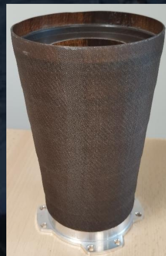
1 er prototype baffle entièrement conçu en lin/RTM6
