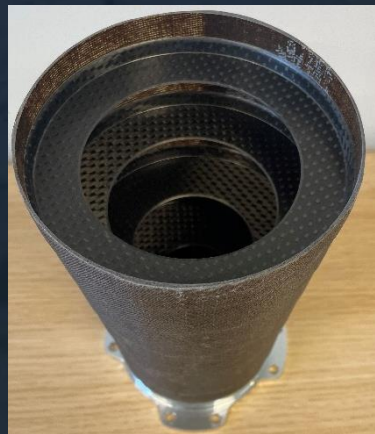
1 er prototype baffle lin/RTM6 avec les vannes CFRP
