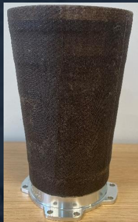
1 er prototype baffle lin/RTM6 avec les vannes CFRP
